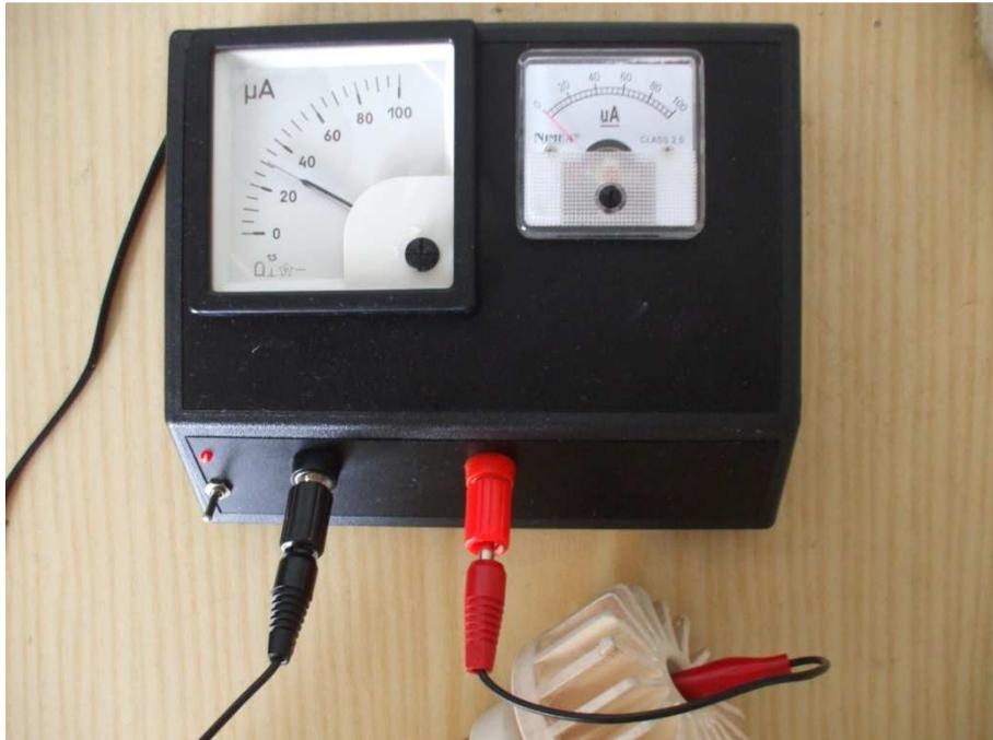
A chi potesse interessare posso dare ulteriori spiegazioni in merito ai molteplici usi di tale circuito che, secondo me, con un piccolo trasformatore per anodica valvolare bastano 800-1000 Volt, qualche decina di mA e un quadruplicatore di tensione per ottenere tensioni dell'ordine 4-6 Kv più che sufficienti a testare la maggior parte dei componenti di normale utilizzo.
