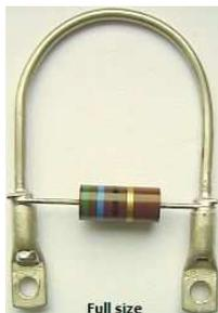
Fig.5 (soppressore anodico)
