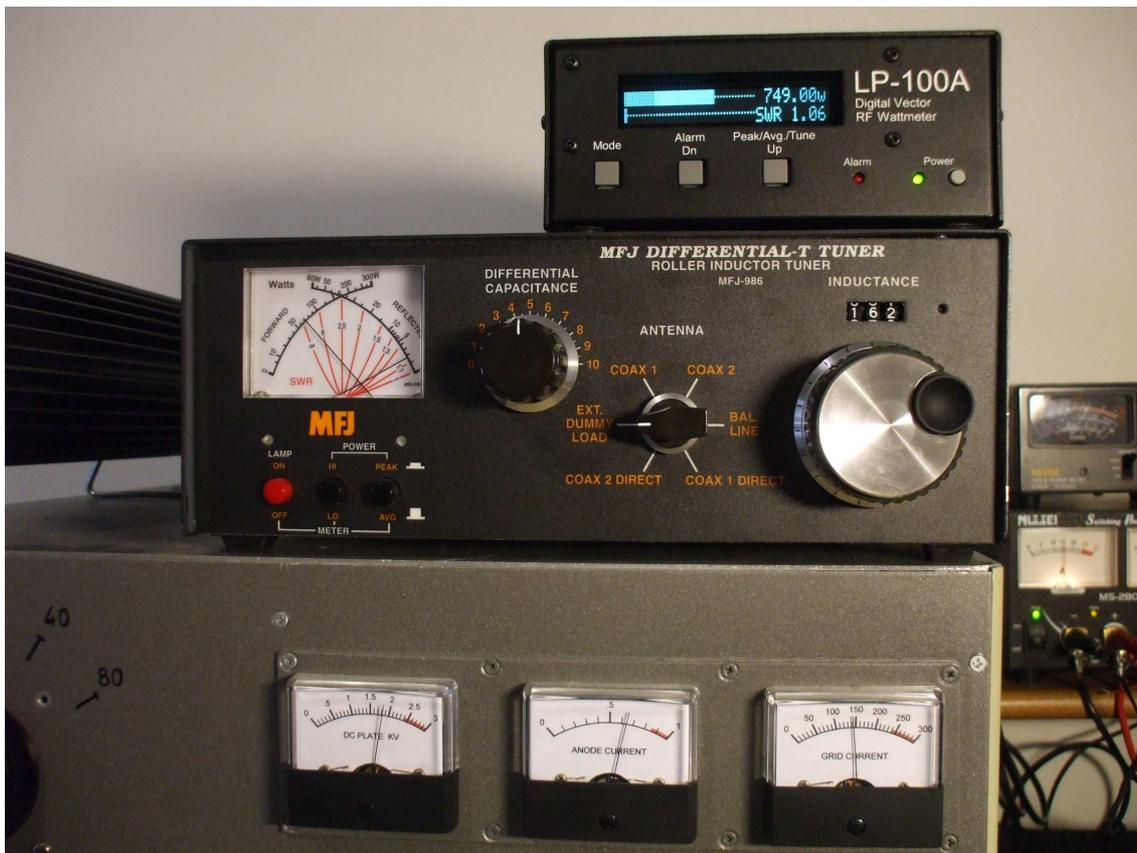
Come si vede dalla foto abbiamo circa 750W in uscita Key-down (portante fissa) FM, in SSB si sfiora il KW P.E.P. e non i 1500W che solo teoricamente si dovrebbero avere, ma mai praticamente.
